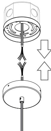
Licensed electrician to terminate Mains Power to Driver Input. Please note the label on the cable for detailed information on wire colors. Power supply must be isolated prior to connection or disconnection of cables. (Connectez l'alimentation principale à l'entrée de l'alimentation. Veuillez noter l'étiquette sur le câble pour des informations détaillées sur les couleurs des fils. L'alimentation doit être isolée avant la connexion ou la déconnexion des câbles.)
