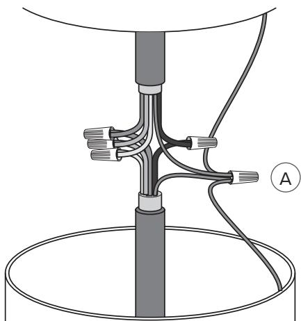
Licensed electrician to terminate ground connections from canopy to ground main input (A). (Connectez la mise à terre du pavillon à la mise à terre de l'alimentation (A).)
